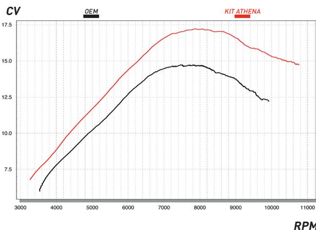
Test eseguito su motore standard con scarico originale e Filtro aria DNA
