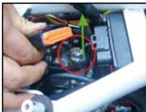
Togliere il connettore della centralina originale della moto; sotto si trova il connettore grigio dell'iniettore da scollegare anch'esso.
