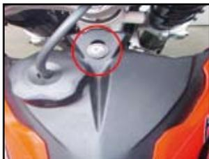
Svitare la vite di fissaggio del serbatoio.
