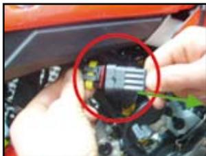
Individuare il connettore della pompa benzina che si trova sotto il serbatoio e scollegarlo.
