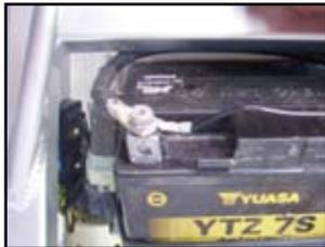
Con l'aiusilio dell'occhietto fornito nel kit, agganciare il cavo nero della centralina GPA al negativo della batteria.
